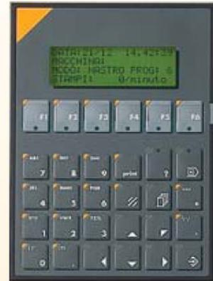
Un PLC comanda tutte le operazioni in automatico con la possibilità di eseguire facili regolazioni tramite la tastiera elettronica provvista di display con "messaggi guida".
